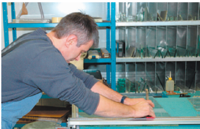
Am Anfang steht der manuelle Zuschnitt der gewünschten Glasplatten.
